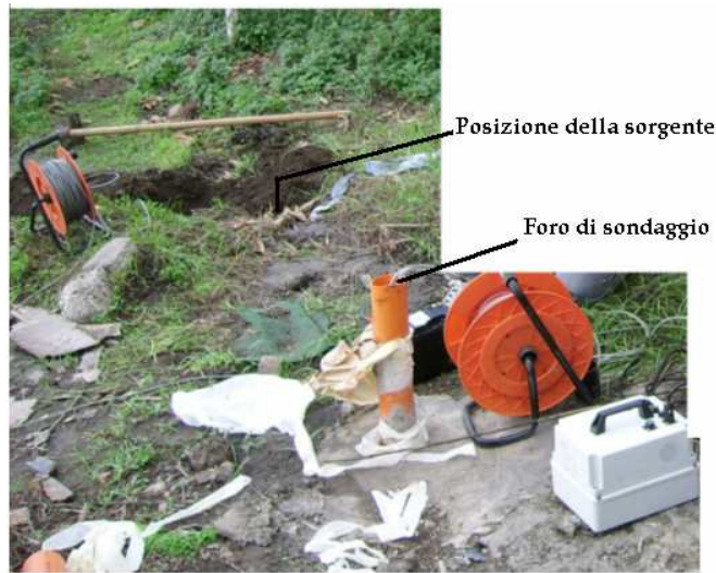
Figura 1: Posizione della sorgente di energizzazione rispetto al foro di sondaggio. In asse con la posizione visualizzata e a valle del foro di sondaggio e stata posizionata un'altra sorgente.
